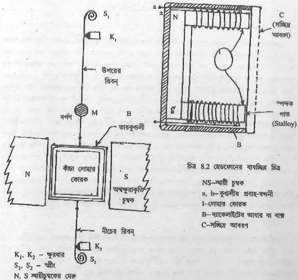
চিত্র 8.2 হেডফোনের ব্যবস্থার চিত্র
